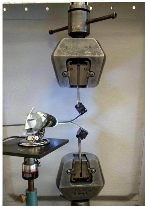
**Figura 21** Disposición del utillaje y cámara digital.
