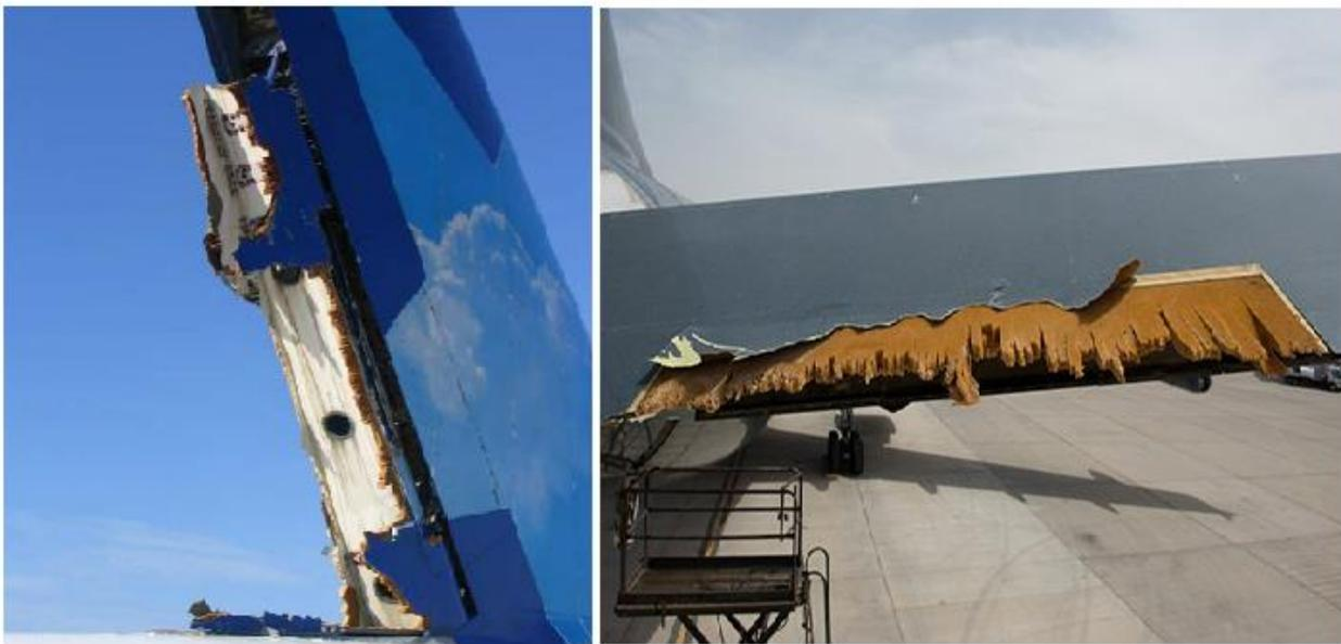
**Figura 5** Ejemplos de deslaminación.
