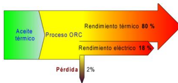
Figura 68. Ejemplo de diagrama de Sankey de un ORC con aceite térmico
