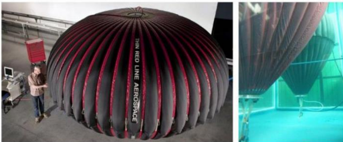
Figura 103. Almacenamiento CAES a presión constante
