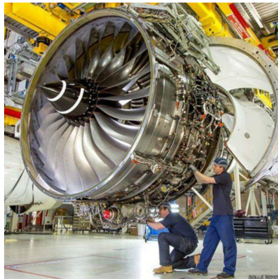
Figura 42. Montaje de una turbina de gas
