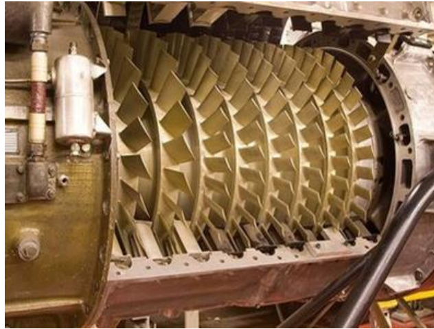
Figura 44. Escalonamientos de una turbina de gas
