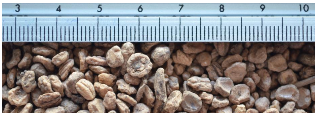
Ilustración 7: Granulometría precursor hueso de aceituna [58]
