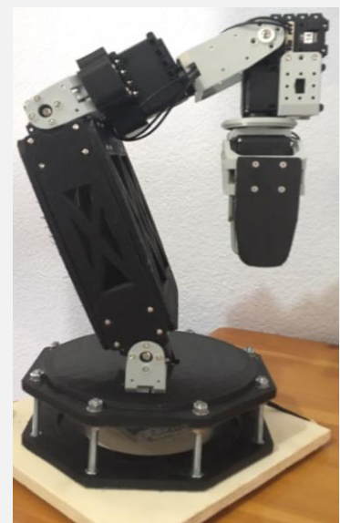
Figura 3-30. Montaje Robot Industrial Paso 18
