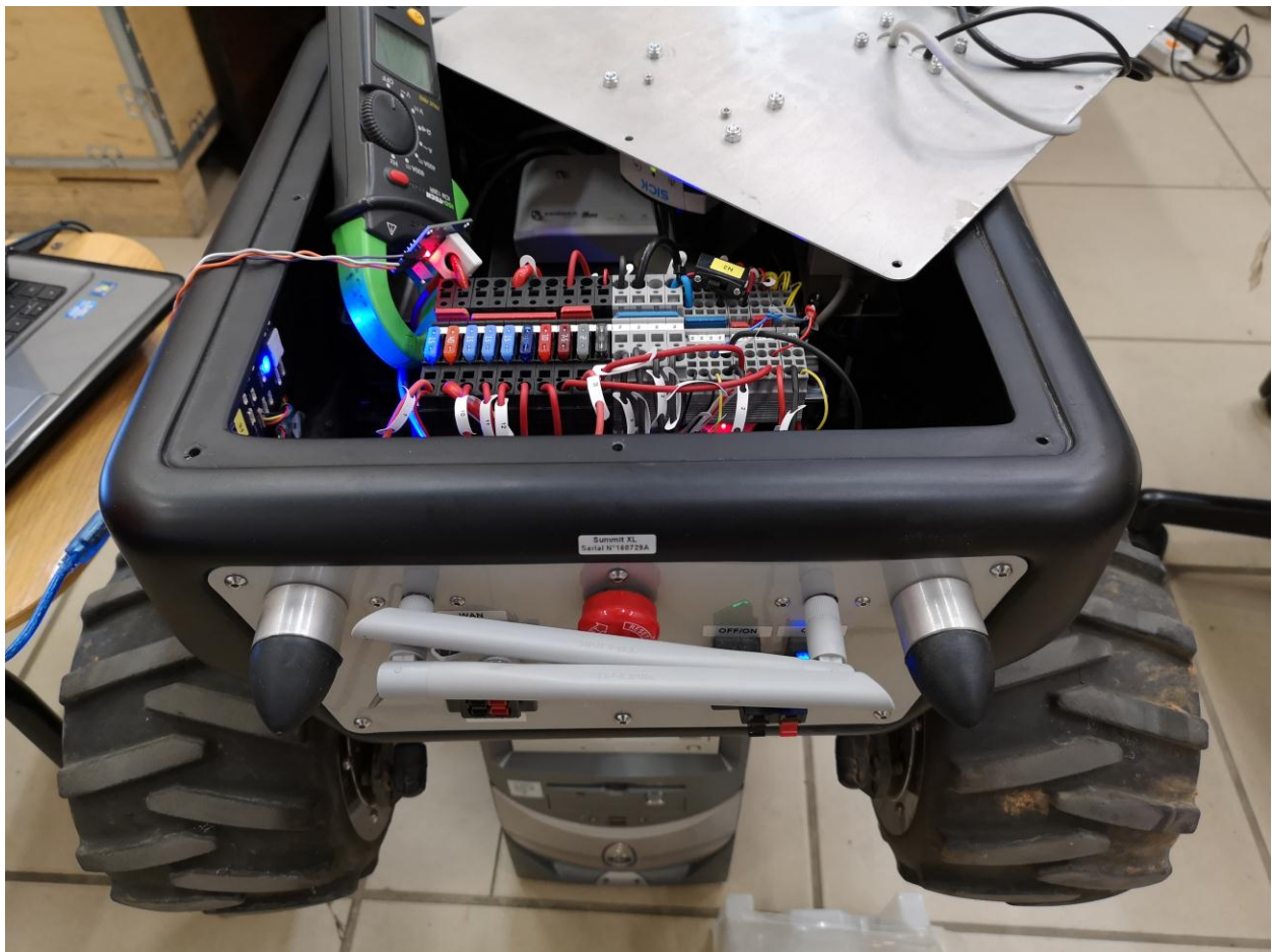
Figura 5-1 Colocación de Pinza Amperimétrica
