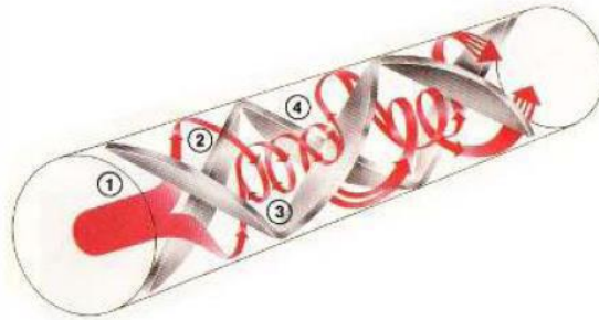
Figura 4-15. Funcionamiento de mezcladores estáticos. Fuente: Handbook of Industrial Mixing
