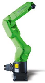
Figura 1-2. Robot colaborativo. FANUC CR-7iA. [2]
