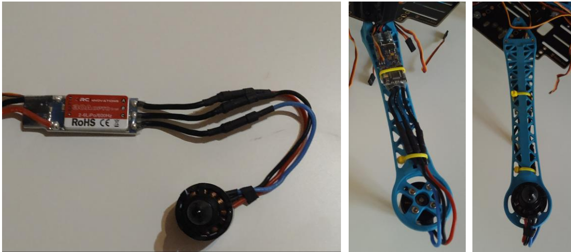
Figura 5.4 Conexión entre el variador y el motor.
