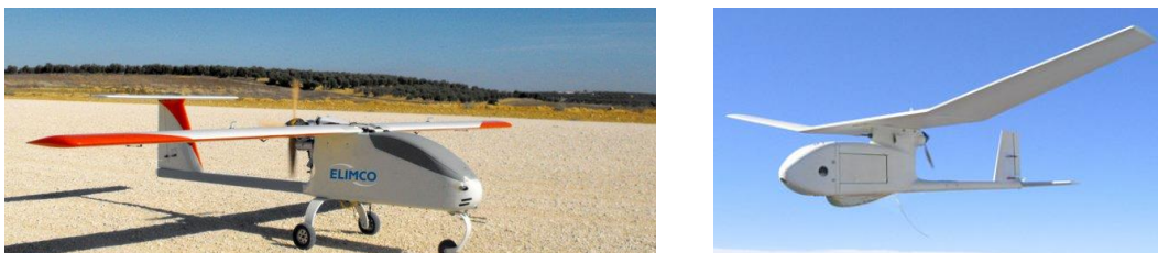
Figura 1.4 Dos ejemplos de RPAS de ala alta: Elimco E500 (izquierda) [30], Raven (derecha) [31].
