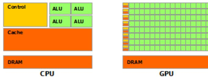
Figura 1-1. Arquitectura de CPU y GPU.
