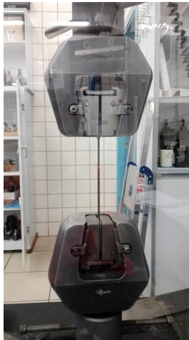
Figura 2.4 - Probeta sobre máquina de tracción.
