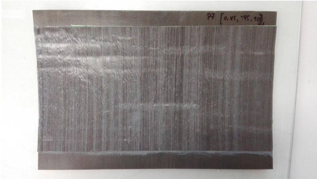
Figura 3.32 – Aspecto del parche pre-curado.
