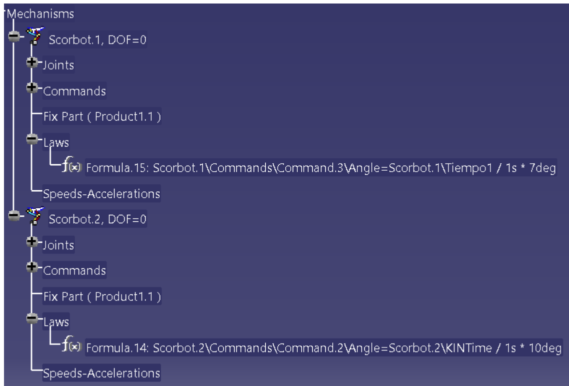
Figura 55. Árbol de Catia. Dos mecanismos con sus leyes de movimiento
