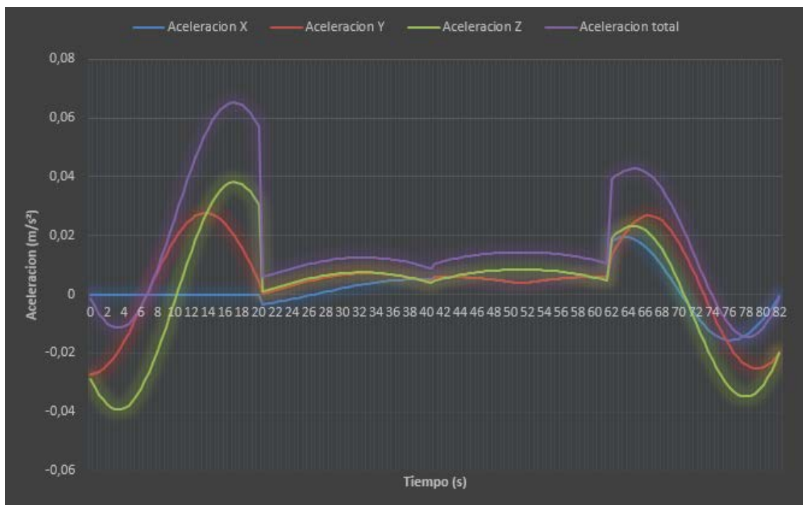
Figura 63. Aceleraciones lineales del extremo de las pinzas durante el movimiento
