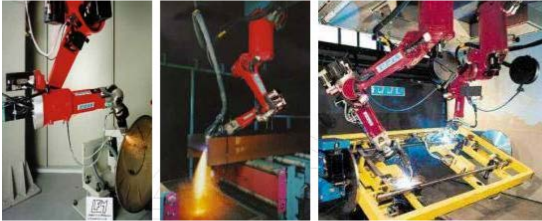
Figura 2. Robots en trabajos de soldadura
