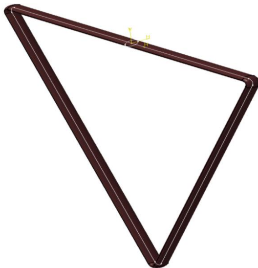
Figura 22: Costilla de la cola, con detalle de la generatriz y la directriz.
