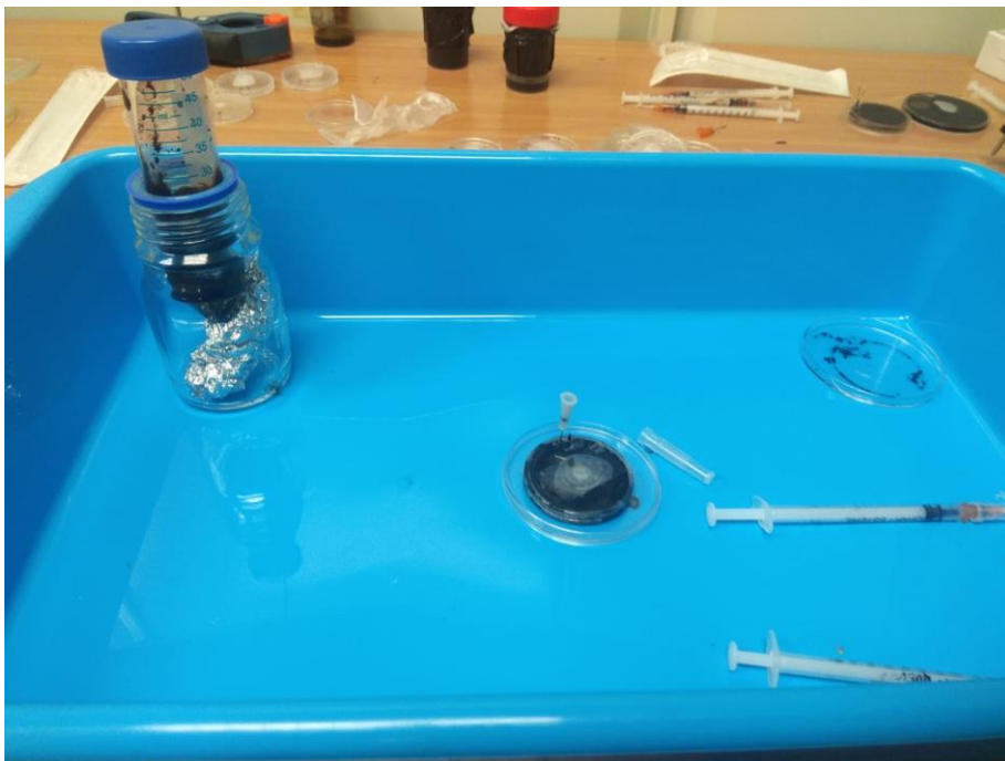
Figura 16. Recipiente utilizado para realizar el llenado de las cápsulas, impregnado de spray hidrófugo.
