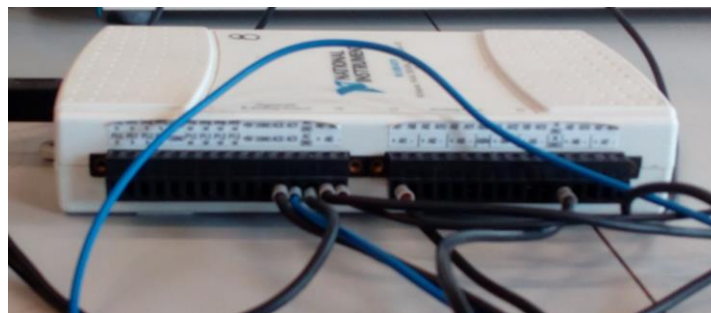
Fig 2: Tarjeta de adquisición de datos NI USB-6211 detalle conexiones.
