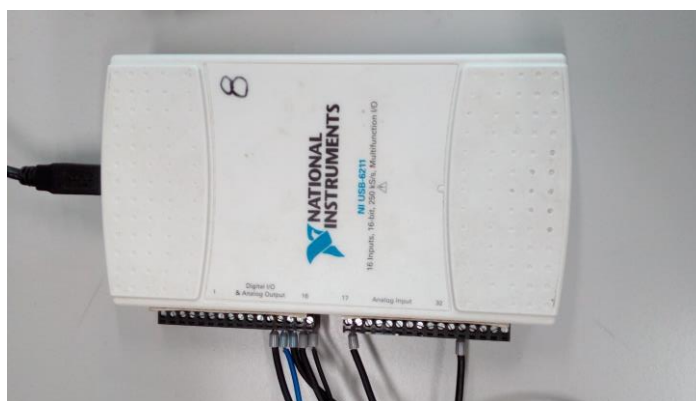
Fig 3: Tarjeta de adquisición de datos de datos NI USB-6211
