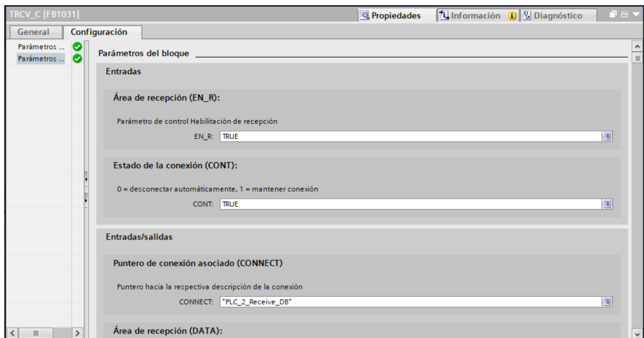
Figura 3.20 Ejemplo parámetros del bloque TRCV_C.
