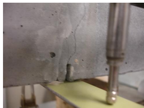
Figura 3-3. Probeta prismática sometida al ensayo de flexión en tres puntos [1]
