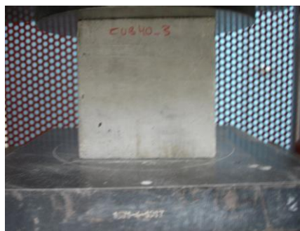
Figura 3-1. Probeta cúbica sometida carga uniaxial de compresión [1]
