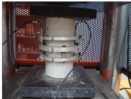
Figura 3-2. Probeta cilíndrica sometida a cargas cíclicas [1]
