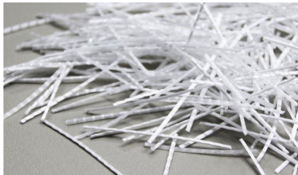
Figura 2-5. Fibras de polipropileno [12]
