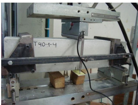
Figura 3-3. Probeta prismática sometida al ensayo de flexión en tres puntos [1]
