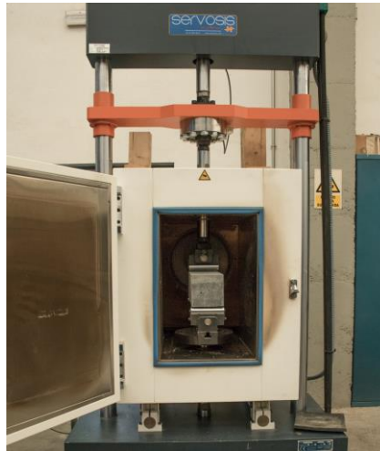
Figura 3-4. Ensayo de flexión en tres puntos a 300°C [5]
