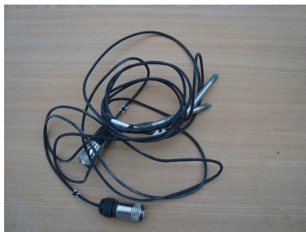
Figura 3-5. Anillos y transductores LVDT utilizados [1]
