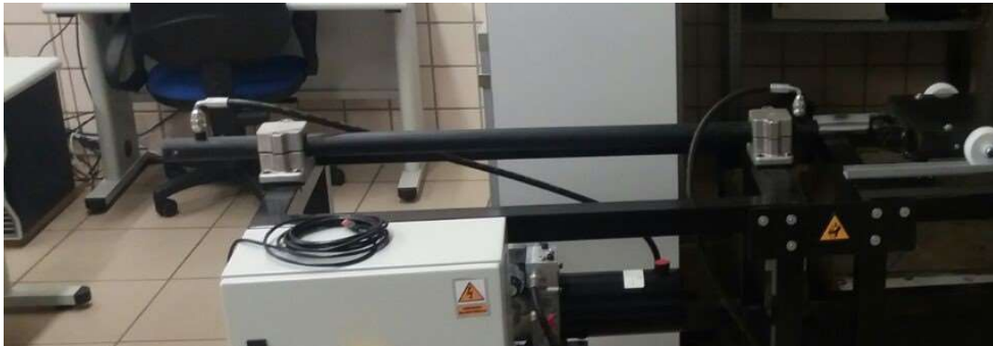
Figura 2.2. Cilindro de doble efecto con el pistón recogido.
