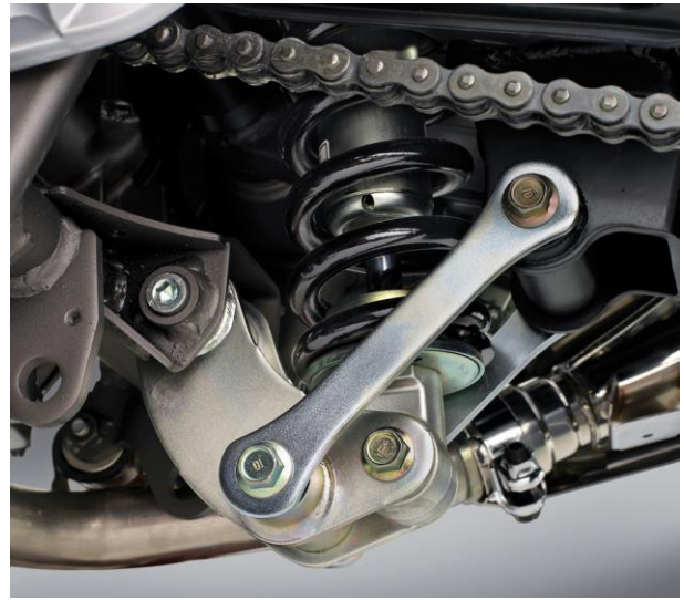
Figura 3-7. Sistema de suspensión Kawasaki (2)
