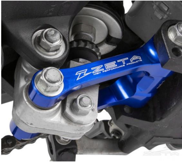
Figura 3-6. Sistema de suspensión Kawasaki (1)
