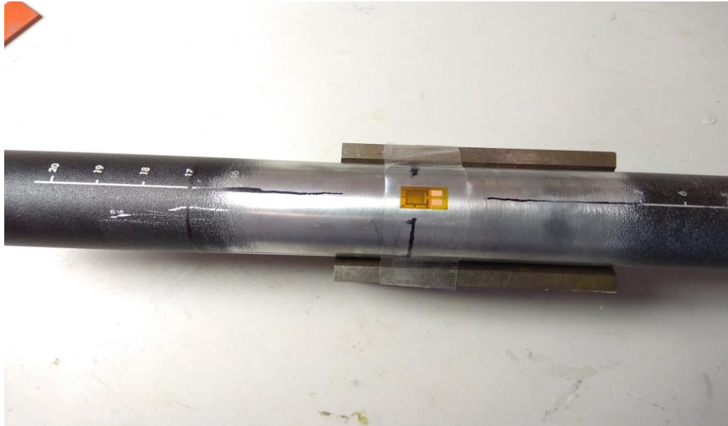
Figura 5-1. Posicionamiento de la galga con celo
