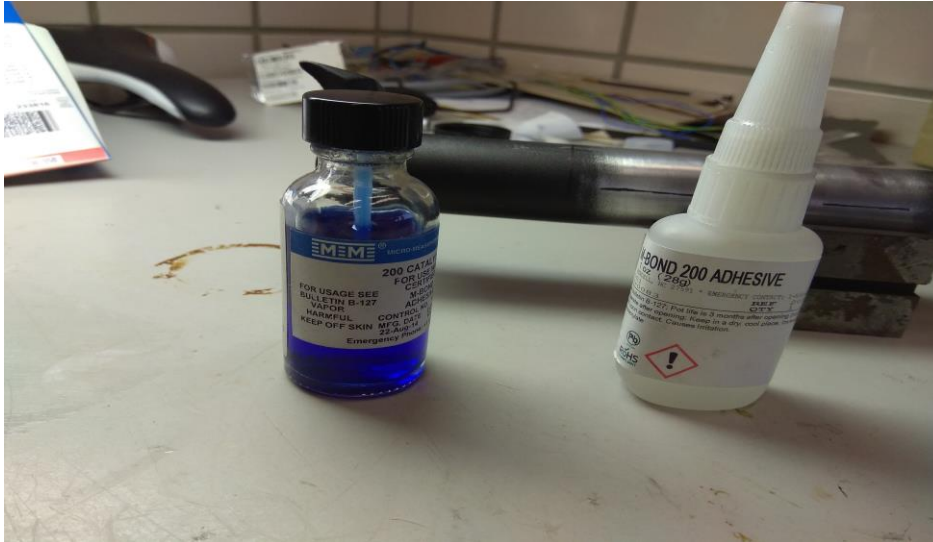
Figura 5-2. Catalizador y pegamento aplicado sobre las galgas
