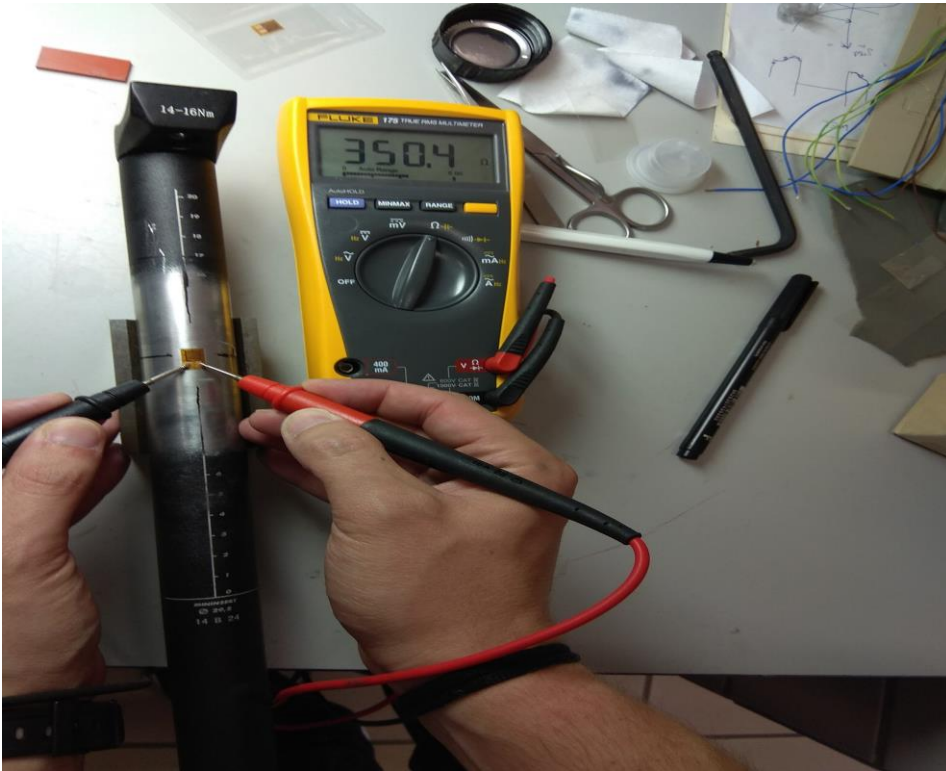
Figura 5-6. Comprobación de la resistencia de la banda
