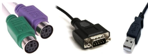
Figura 3.3. Tres tipos de interfaces: PS/2; RS-232 y USB
