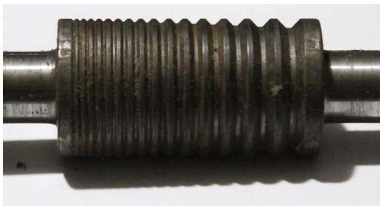
Figura 113. Perfil del cilindro de laminación de hilo a medir.
