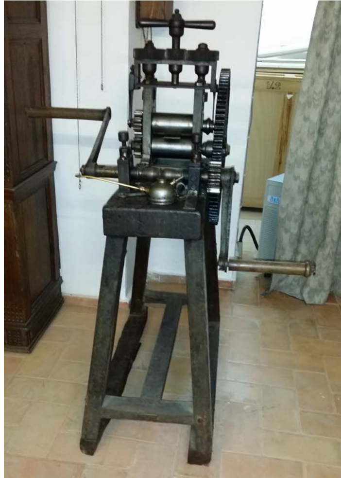
Figura 23. Laminadora manual perteneciente al taller de Fernando Marmolejo y expuesta en Museo de Artes y Costumbres Populares de Sevilla.
