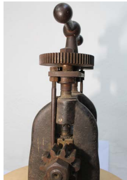
Figura 39. Engranaje lateral con eje roscado en el cuerpo.
