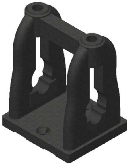
Figura 120. Cuerpo de la laminadora y elementos de apoyo del eje inferior de laminación.
