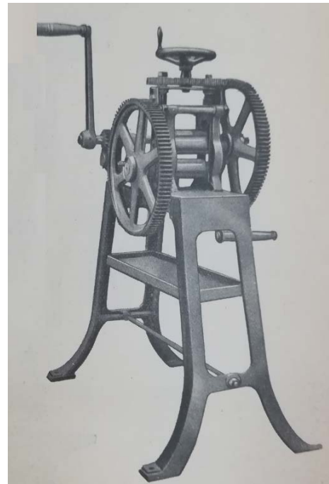
Figura 20. Laminadora de acción indirecta mediante juego piñón-corona en ambos ejes, superior e inferior [11].
