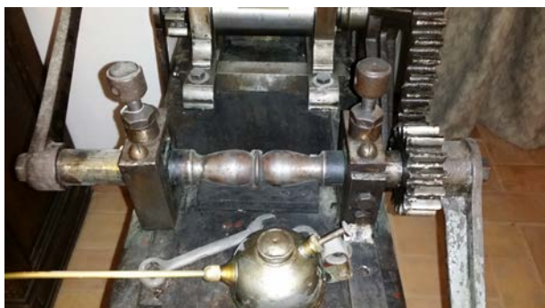
Figuras 24 y 25. Eje de rotación accionado a través de dos manivelas y transmisión de dicho movimiento giratorio al eje inferior de trabajo de la laminadora.
