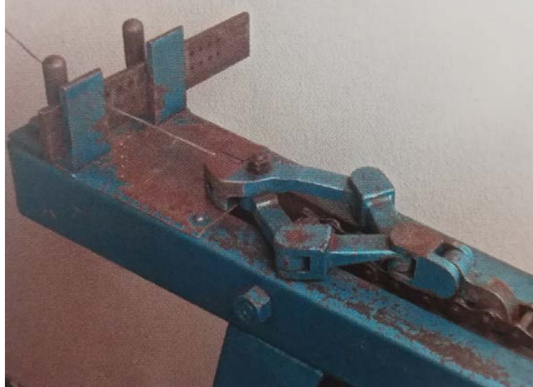
Figura 34. Estirado de hilo a través de hilera circular en banco de estirado.
