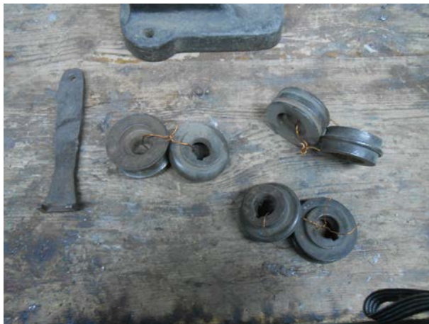
Figuras 43 y 44. Palanca y juego de cabezales o discos operadores para la bordonadora del taller de Marmolejo Orfebres.
