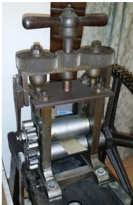
Figura 26. Sistemas de engranaje para la transmisión de movimiento rotatorio de un eje de trabajo a otro y para desplazamiento vertical del rodillo superior.
