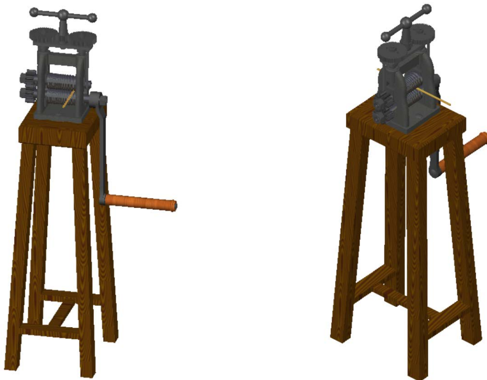
Figuras 152 y 153. Vistas de la laminadora de hilo sobre bancada.
