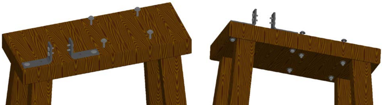
Figuras 64 y 65. Vistas de elementos de fijación a la bancada.
