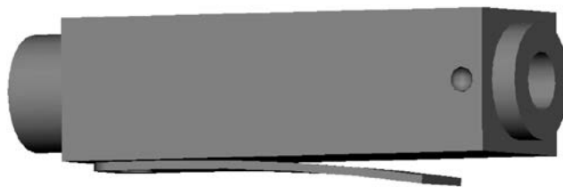
Figura 184. Bloque con chapa-muelle atornillada a su base.
