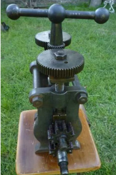
Figuras 21 y 22. Combinación engranaje-tornillo para transformar el movimiento giratorio de la llave o rueda superior en la traslación vertical del eje del rodillo superior.
