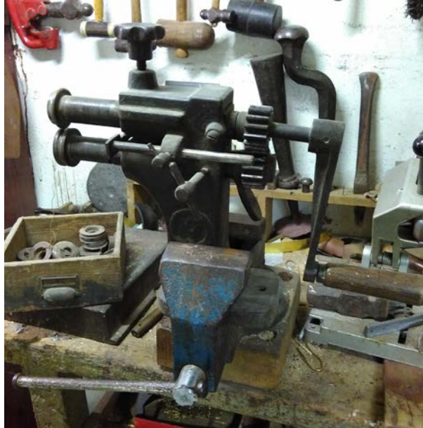
Figura 42. Bordonadora anclada mediante tornillo de banco en el taller Marmolejo Orfebres.
