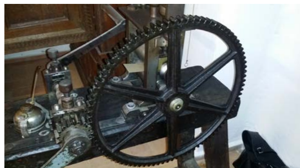
Figuras 24 y 25. Eje de rotación accionado a través de dos manivelas y transmisión de dicho movimiento giratorio al eje inferior de trabajo de la laminadora.
