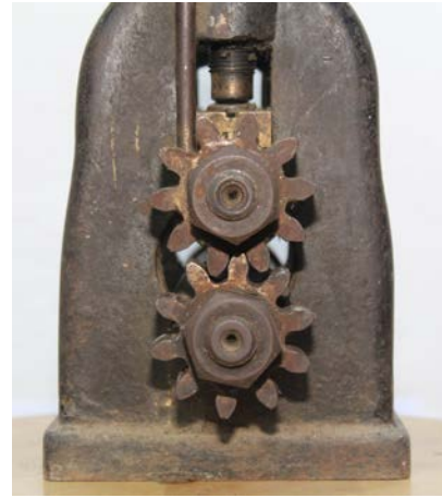
Figura 37. Vista lateral de los engranajes para la transmisión de movimiento giratorio entre ejes.
