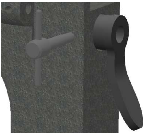
Figura 191. Tornillo con manija para fijar la posición de la palanca.
