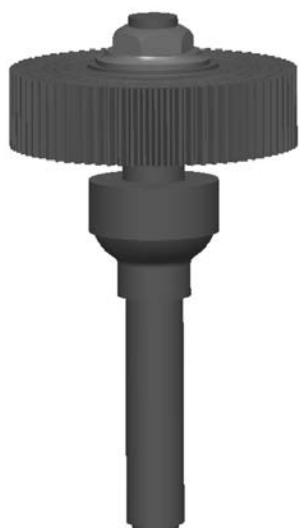
Figura 96. Engranaje lateral con eje roscado.
