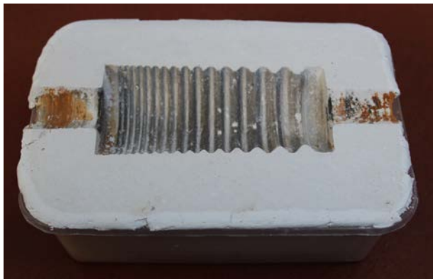
Figuras 115 y 116. Moldes de escayola del cilindro de laminación.
