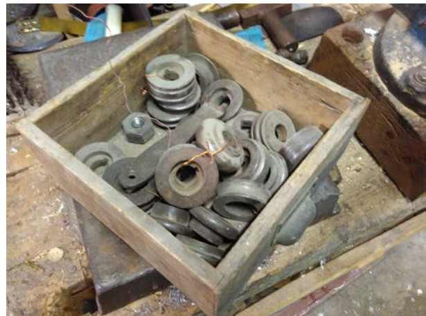
Figuras 43 y 44. Palanca y juego de cabezales o discos operadores para la bordonadora del taller de Marmolejo Orfebres.
