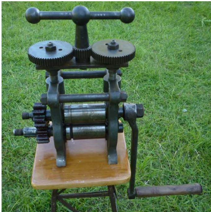
Figura 19. Laminadora manual de acción directa mediante manivela en el eje superior.
