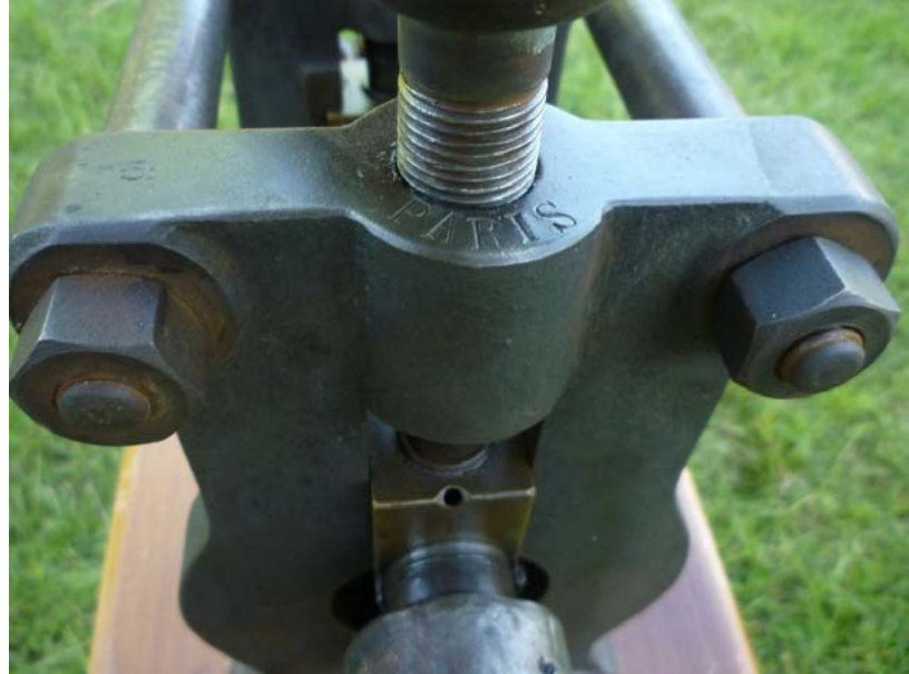
Figuras 21 y 22. Combinación engranaje-tornillo para transformar el movimiento giratorio de la llave o rueda superior en la traslación vertical del eje del rodillo superior.
