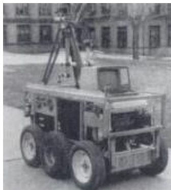
Figura 3-3. Robot con configuración skid-steering (Fuente: [13])
