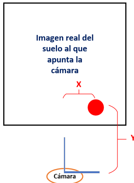
Figura 6-8. Distancias a medir del objeto a la cámara
