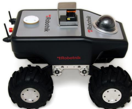
Figura 3-1. Summit-XL en configuración Skid-Steering (Fuente: [12])
