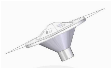
Figura 3-7. Alternativa de chapa con forma toroidal y tapa de plástico.
