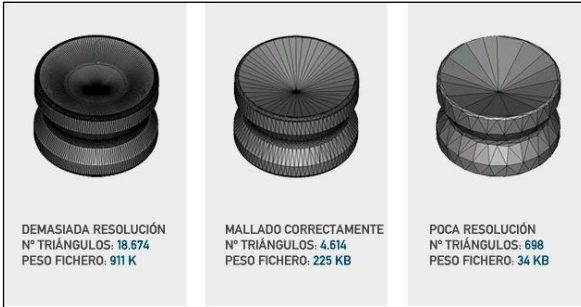
Figura 5. Ejemplo de resolución de un archivo según el número de triángulos y como consecuencia el peso digital de dicho archivo (63).
