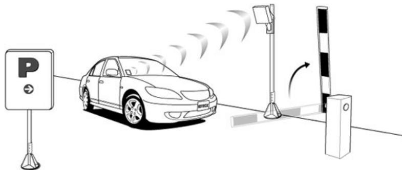
Figura 3-2. Cobro electrónico de peajes (Fuente: [www.imasdetres.com](http://www.imasdetres.com))
