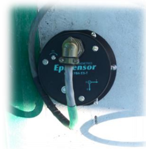
Figura 3-14: Tipo de sensor utilizado en el ensayo de vibración ambiental. Fuente: Acciona.
