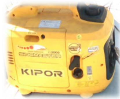
Figura 3-16: Generador eléctrico utilizado en el ensayo de vibración ambiental. Fuente: Acciona.
