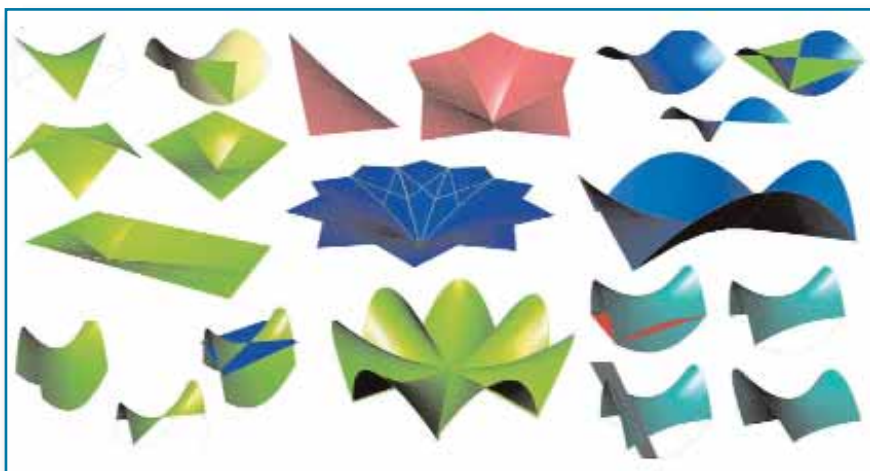
Fig. 7. Modelado digital de algunas posibilidades de combinación del paraboloides hiperbólico.
