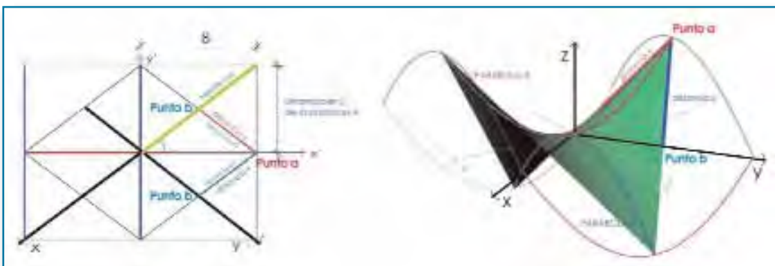
Fig. 6. Ubicación de puntos en la superficie de un paraboloides hiperbólico.
