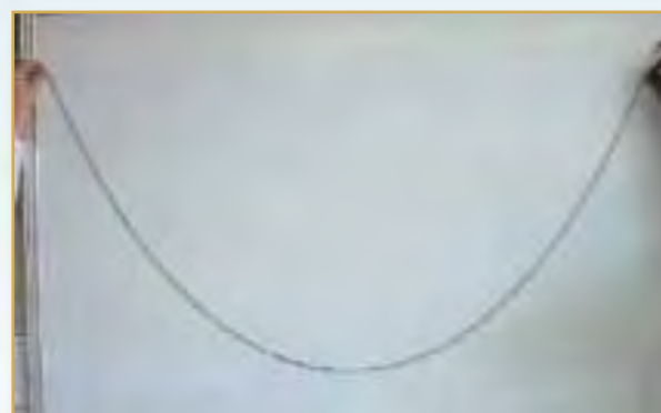
Fig. 2: Cadena colgante, trabajando a tracción, formando una Catenaria.
