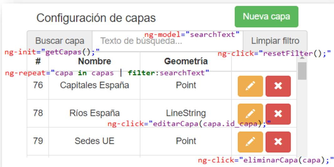
*Ilustración 23: Relación entre la vista y los métodos Javascript en el panel de configuración de capas*
