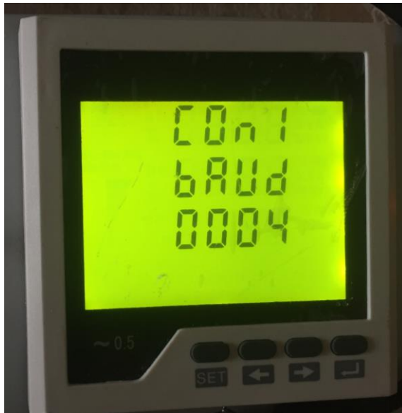
Ilustración 44: Propiedades sistema, en el prototipo. Velocidad de transmisión 9600 baud
