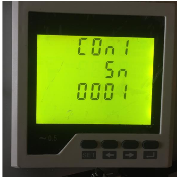
Ilustración 42: Propiedades sistema, en el prototipo. Dirección esclavo número 1
