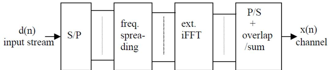
FIGURA 4. 16 BANCO DE FILTROS BASADO EN UN TRANSMISOR IMPLEMENTADO CON FFT
