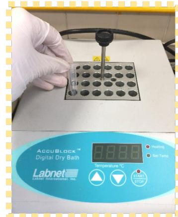
**Figura 8. Tubo Eppendorf en placa calefactora.**
