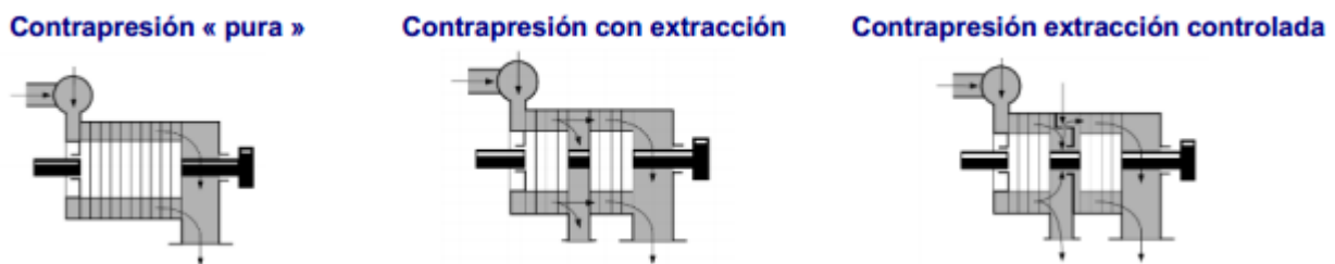
Figura 1-8 Turbinas a contrapresión y con extracción.
