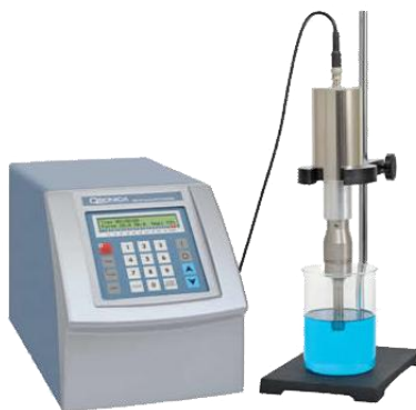
Imagen 1: Sonicador digital por ultrasonidos de 500 Watt. “Q500”
