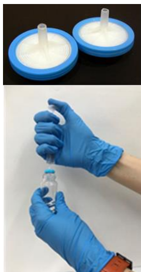
Imagen 2: Microfiltros y proceso de microfiltración
