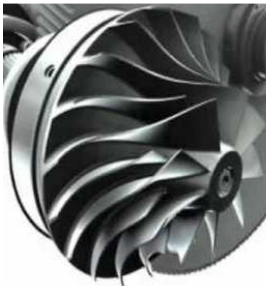
Figura 22. Rodete con álabes sin zona inductora.
