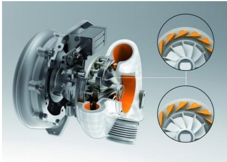
Figura 2.8. Turbo con dos espirales de entrada a la turbina (www.motorpasion.es)
