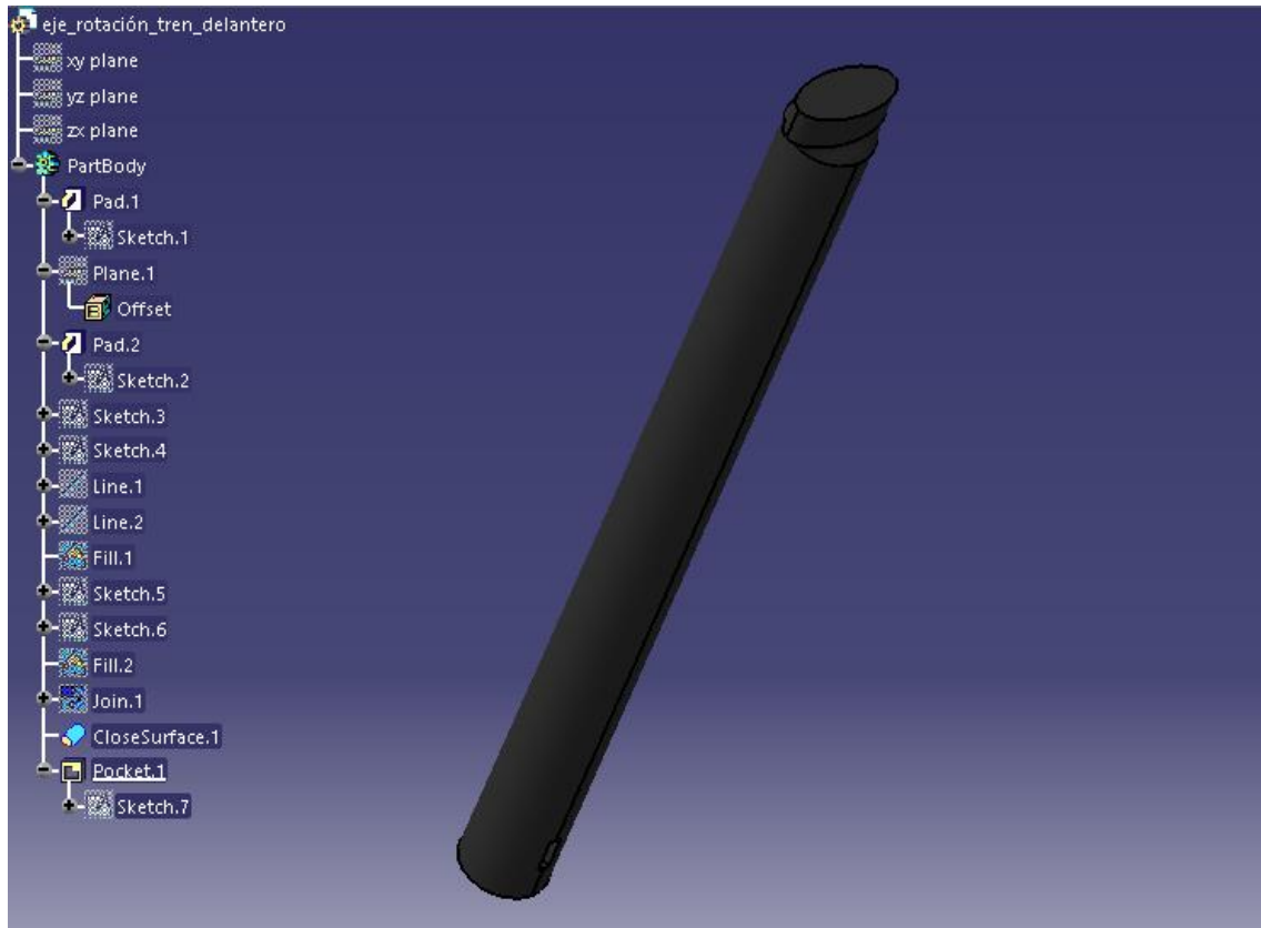
Figura 87. Eje de rotación del tren delantero
