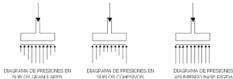
Ilustración 28_Diagrama de esfuerzos de las zapatas en diferentes tipos de terrenos, extraída de internet
