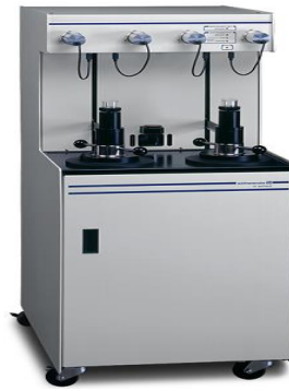
Figura 11. Porosímetro de mercurio empleado para adquirir los resultados relacionados con la porosidad de los imprimidos.
