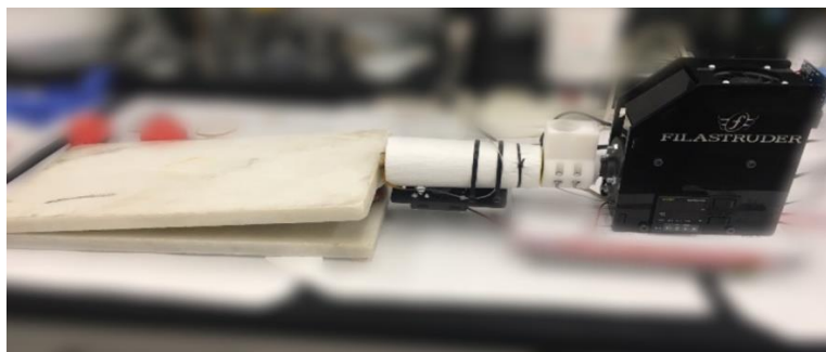
Figura 8. Imagen de la extrusora Filastruder Kit® durante el proceso de elaboración de filamentos.
