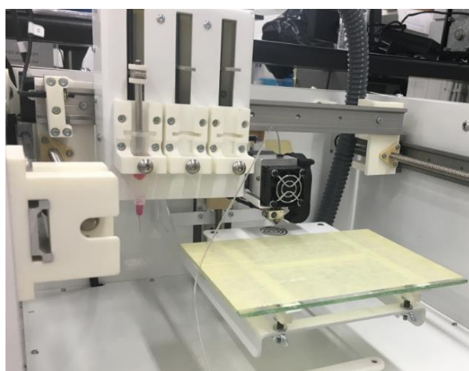
Figura 4. Impresora constituida por cabezales de inyección de tinta (IVF) y FDM.
