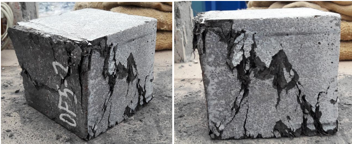
FIGURA 20 a) y b). Probeta DSL+PP ensayada compresión simple. Fuente: Fotografía tomada in situ .
