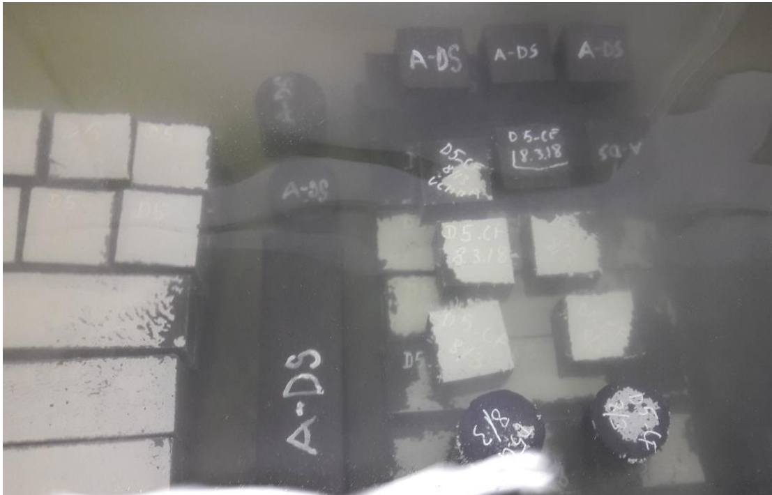
FIGURA 16. Probetas de hormigón de ultra-altas prestaciones reforzados con fibras en baño térmico. Fotografía tomada in situ .
