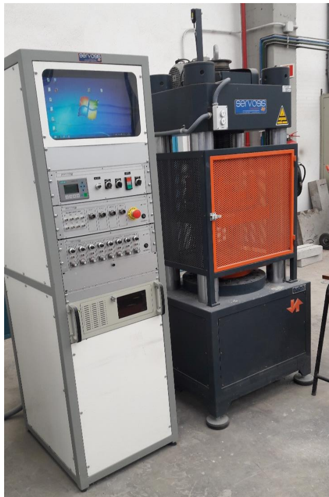
FIGURA 17. Panel de control Servosis y Prensa hidráulica Servosis modelo MES 300. Fotografía tomada in situ .
