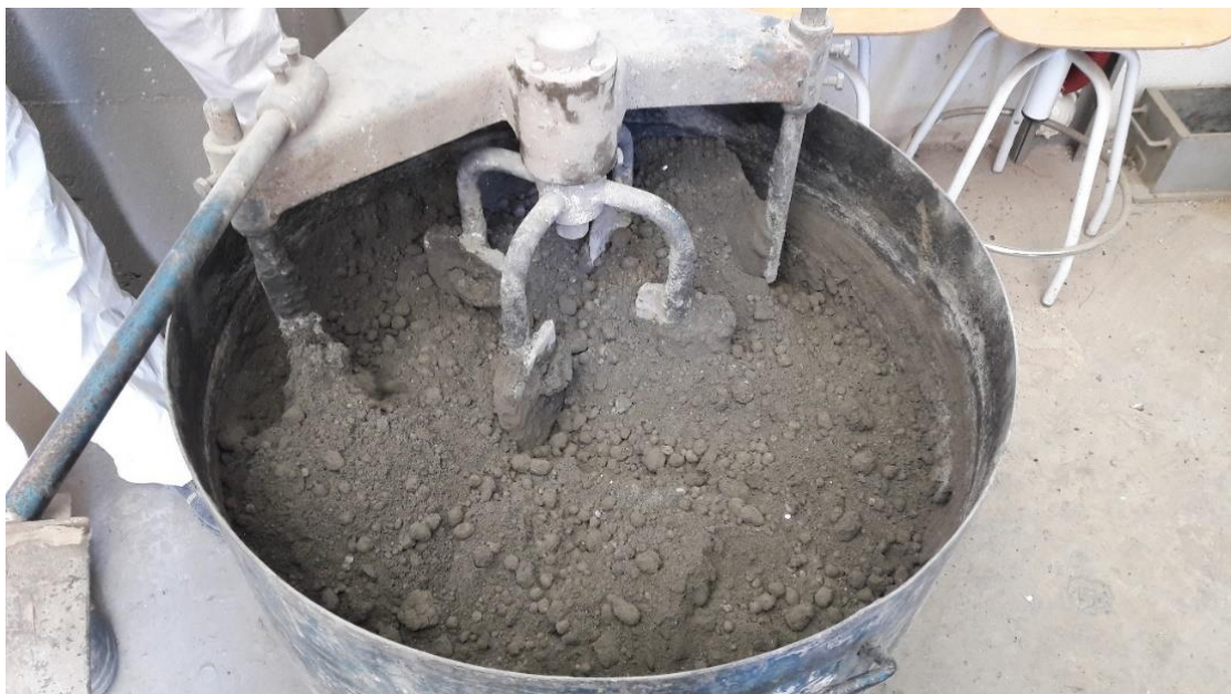
FIGURA 12. Mezcla con adición superplastificante y agua. Fotografía tomada in situ .
