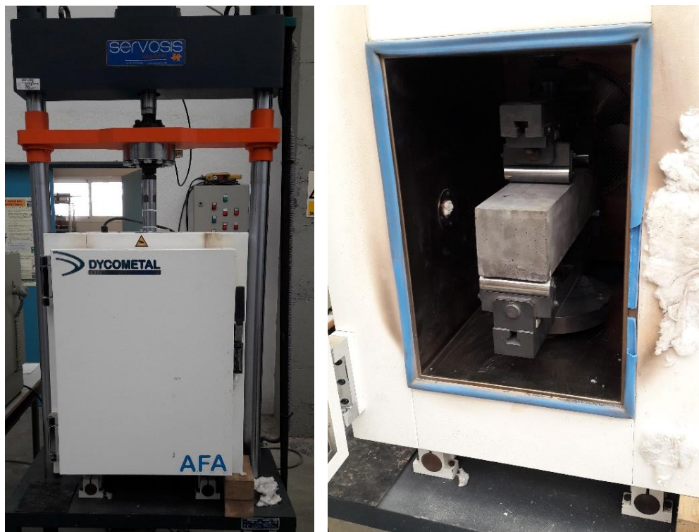
FIGURA 24 a) y b). Ensayo de flexión en 4 puntos en horno a 300°C. Fuente: Fotografía tomada in situ .
