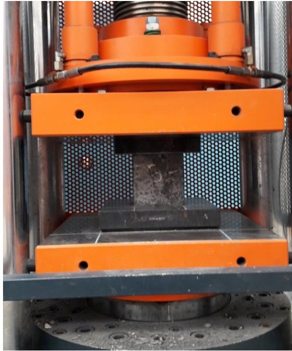
FIGURA 19. Ensayo de compresión simple. Fuente: Fotografía tomada in situ .
