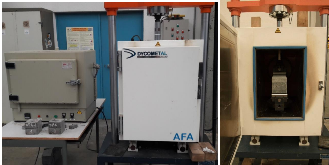
FIGURA 18 a) y b). Horno y máquina servo hidráulica modelo ME 406/15 marca Servosis. Fotografía tomada in situ .
