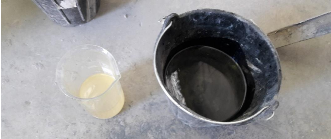
FIGURA 9. Superplastificante BASF 325 y agua. Fotografía tomada in situ .
