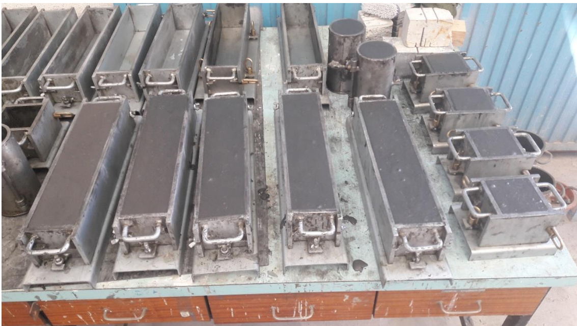
FIGURA 14. Moldes de las probetas de hormigón. Fotografía tomada in situ .
