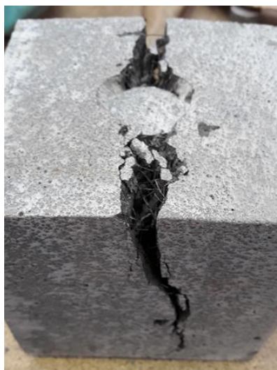
FIGURA 30. Fibras en grietas de probeta DSL+PP. Fuente: Fotografía tomada in situ .
