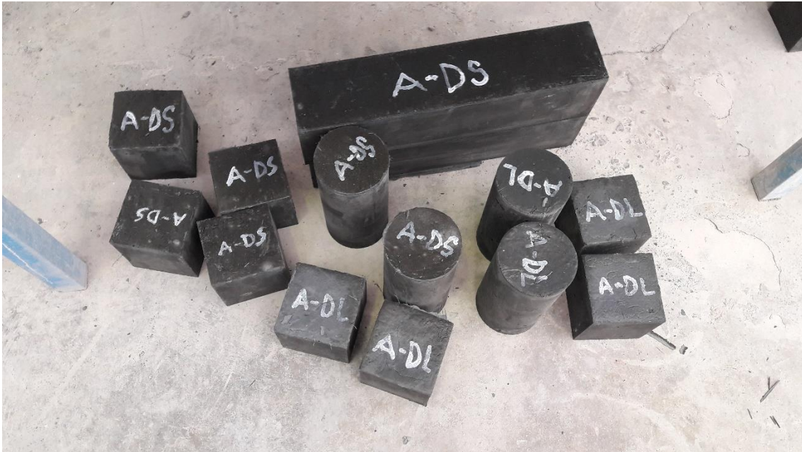
FIGURA 15. Probetas de hormigón de ultra-altas prestaciones reforzados con fibras. Fotografía tomada in situ .
