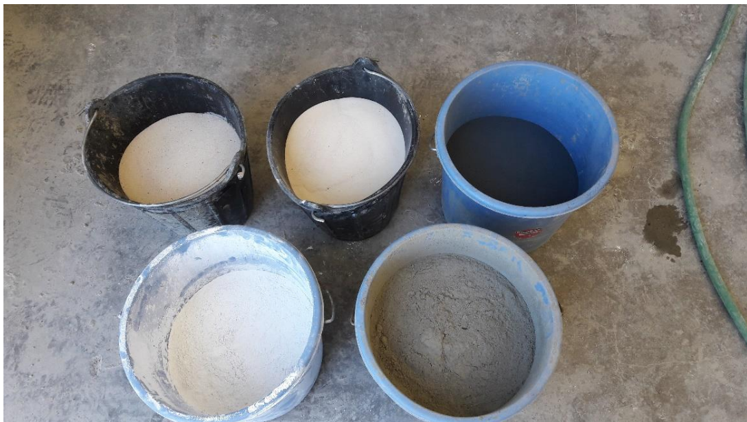
FIGURA 8. Arena AS-F, arena AS-V, humo de sílice, escoria sin caliza y cemento. Fotografía tomada in situ .
