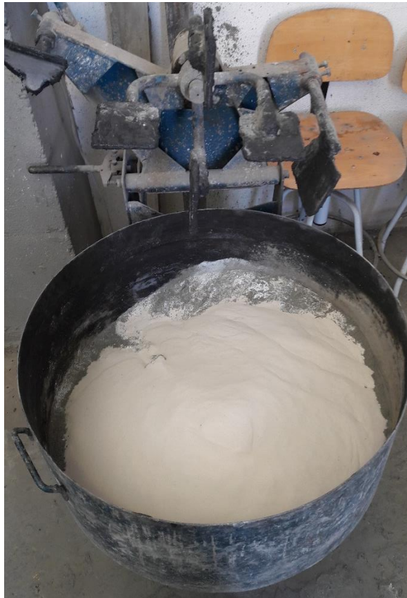
FIGURA 11. Antes de mezclar componentes secos. Fotografía tomada in situ .
