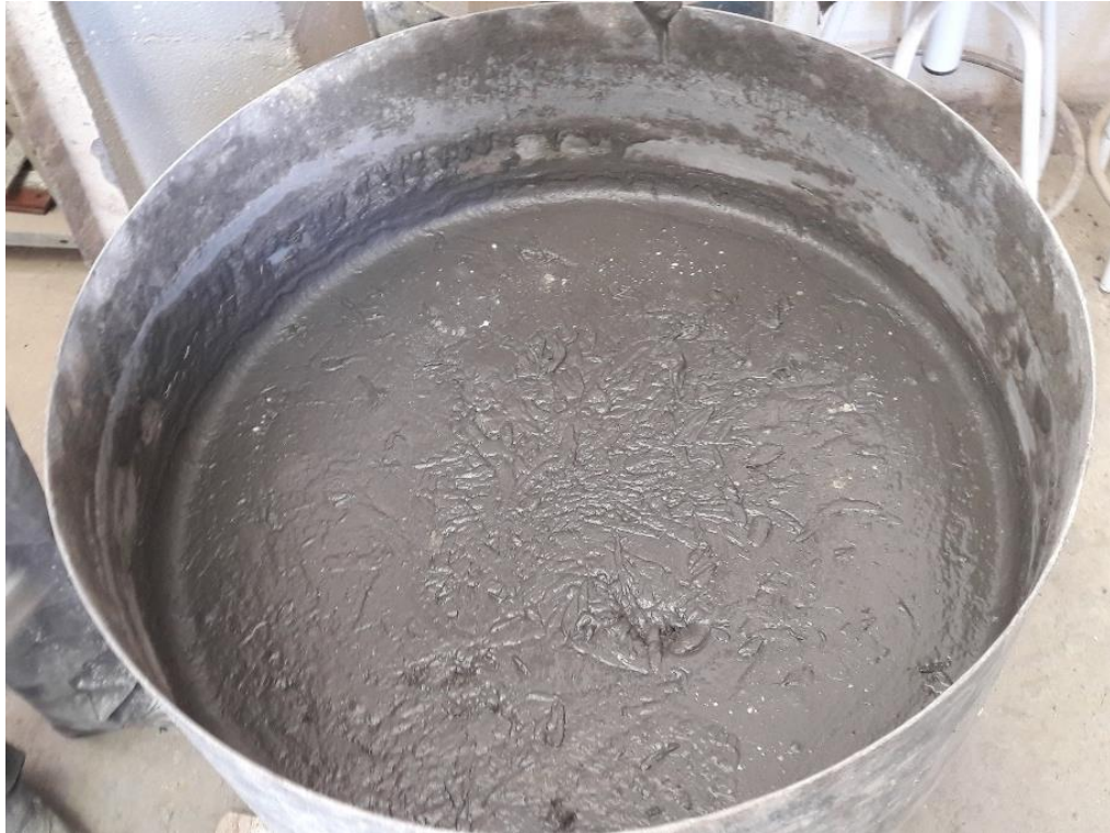
FIGURA 13. Hormigón de ultra-altas prestaciones reforzado con fibras en estado fresco. Fotografía tomada in situ .
