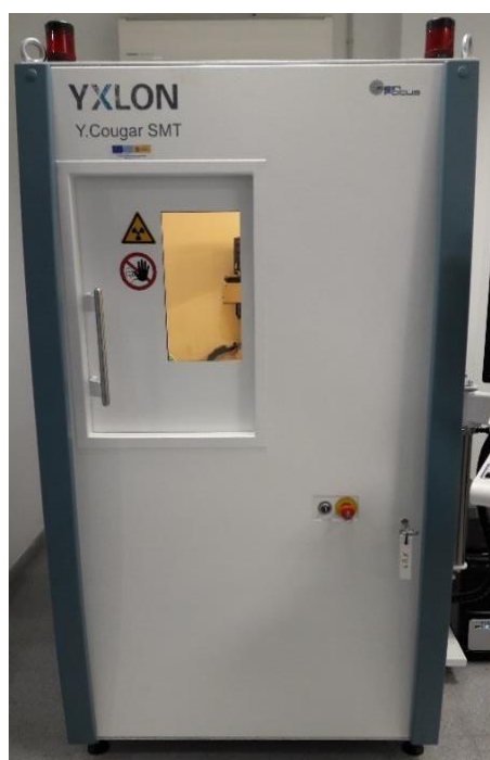
FIGURA 39. Equipo de inspección de rayos X, modelo Y.Cougar SMT de la compañía YXLON. Fuente: Fotografía tomada in situ .
