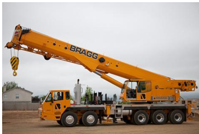
Figura 8–1. Grúa telescópica sin cadenas para desmantelamiento y montaje de los aerogeneradores
