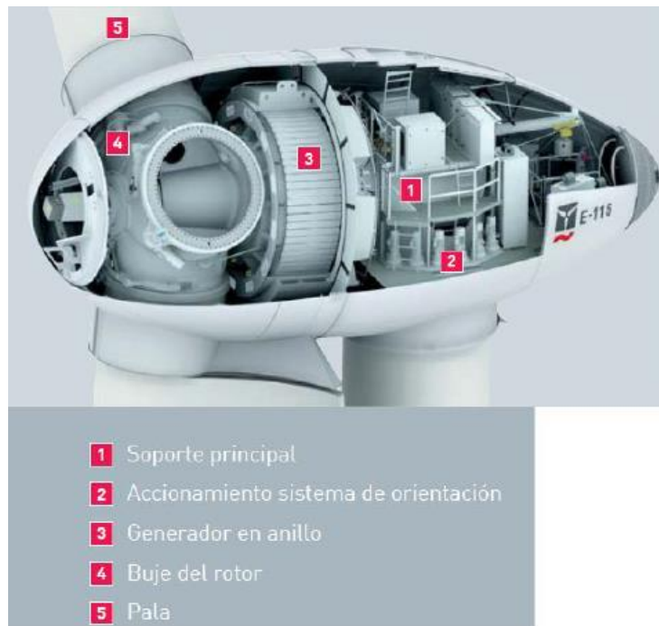
Figura 5-3. Sección del modelo E-115 instalado actualmente
