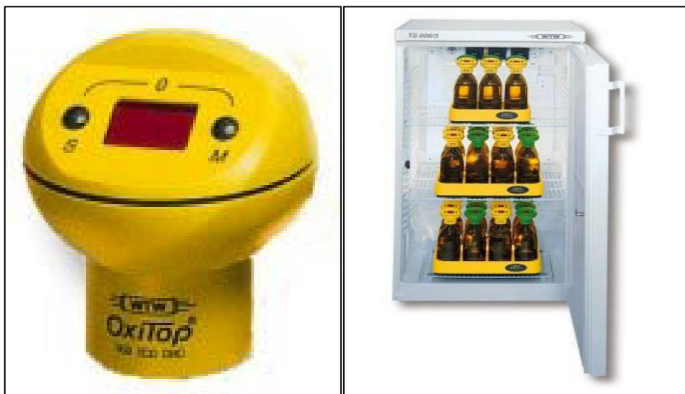
Figura 7. Cabezal del oxitop y cabina termostática.
