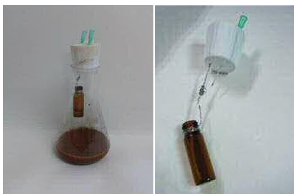
Figura 8. Respirómetro empleado para los estudios de mineralización de contaminantes y trampa de álcali antes de ser incorporada al matraz erlenmeyer.
