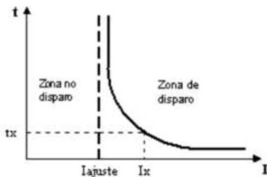
Figura 39. Ejemplo de actuación de relé de sobreintensidad de tiempo inverso
