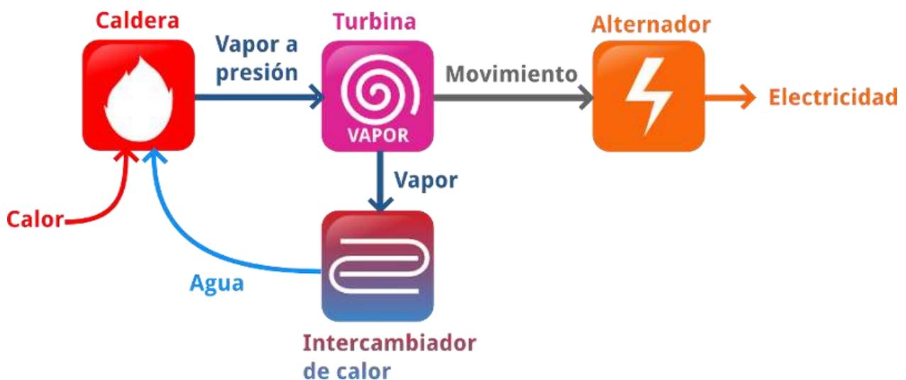
Figura 14 Esquema de funcionamiento de una central térmica
