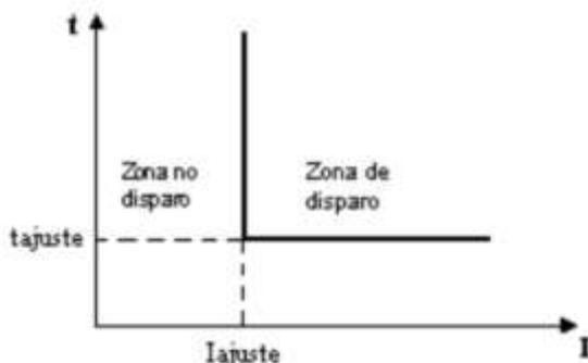
Figura 40. Ejemplo de actuación en relé de sobreintensidad de tiempo definido
