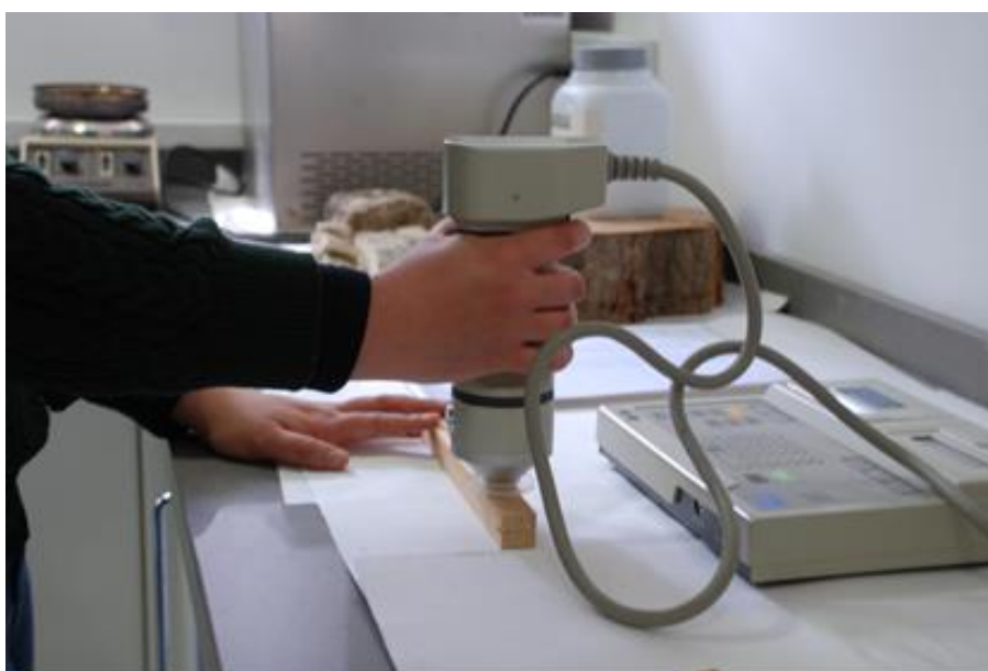
Figura II.16. Mediciones de colorimetría en las muestras de madera.
