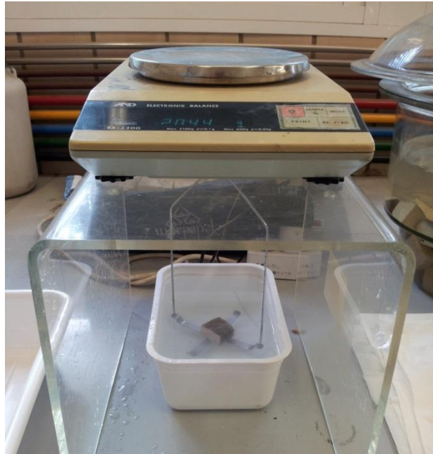
Figura II.17. Pesada hidrostática de probetas de ataurique para medir la porosidad abierta.
