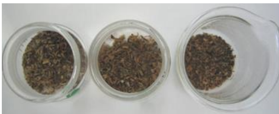
Figura II.5. Muestras de cuero cortadas en forma de virutas en vasos de precipitado.
