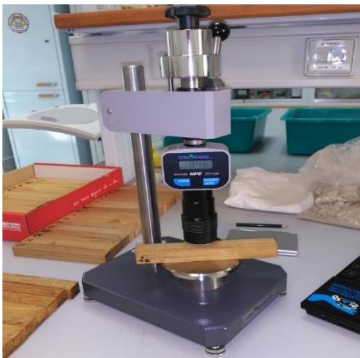
Figura II-18. Medida de la dureza superficial.
