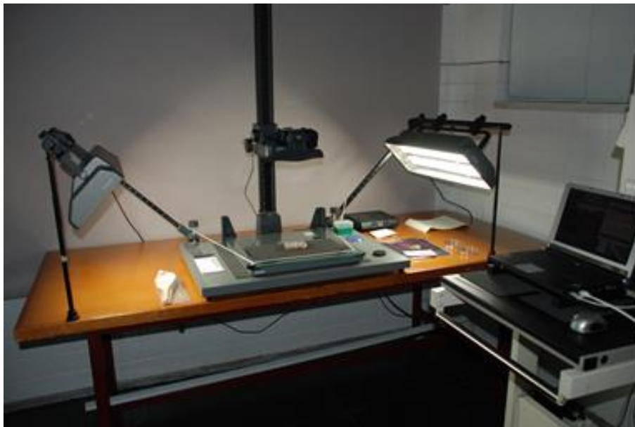
Figura II.14. Toma de imagen fotográfica para evaluar el crecimiento fúngico tras la aplicación de biocidas.
