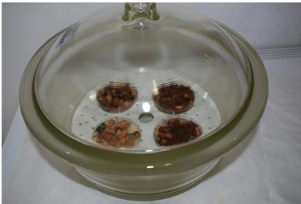
Figura II.15. Probetas de madera en el desecador para favorecer el crecimiento de especies fúngicas.
