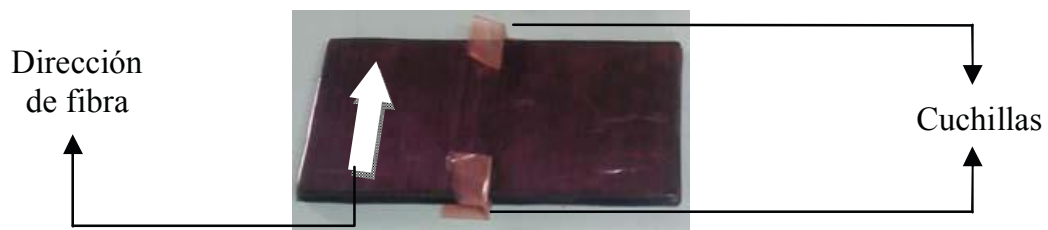
Fig. 2. Laminado con fibras paralelas a la grieta de la serie 1
