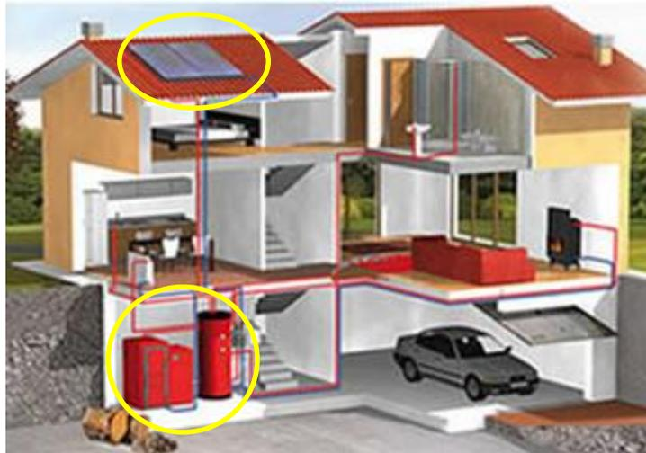
Figura 31: Vivienda unifamiliar con instalación mixta biomasa-solar.
