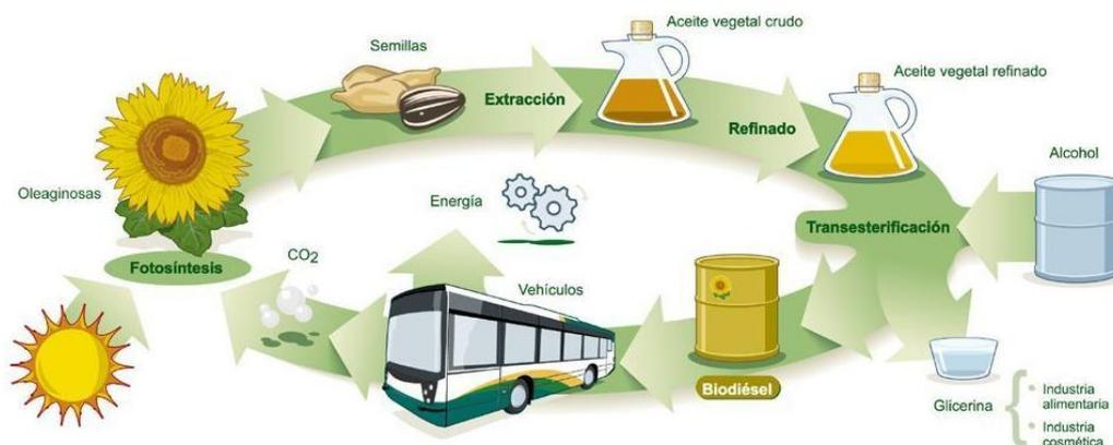
Figura 7: Proceso obtención biodiesel. [27]
