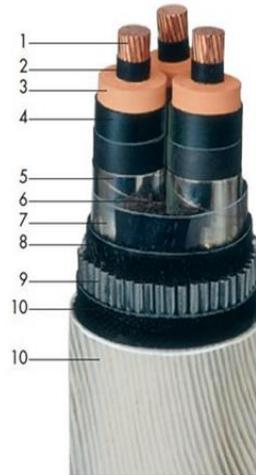
Figura 5. Arquitectura del cable submarino
