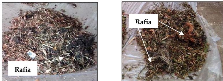
Fig. 2.4. Rafia contenida en los RAI tras su trituración en la planta de tratamiento de residuos.
