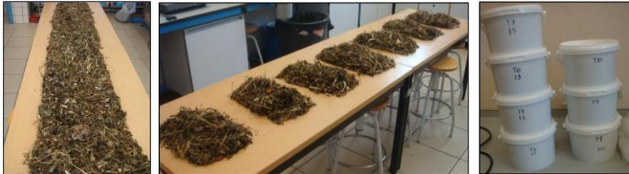
Fig. 2.19. División y almacenamiento de las muestras de RAI para su manejo posterior.
