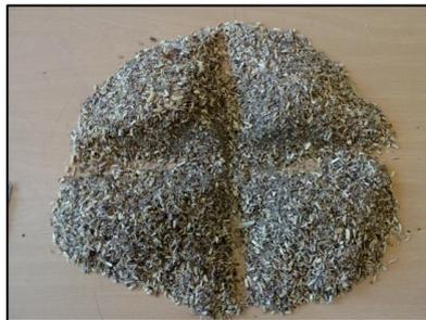
Fig. 4.10. (Izda.) Muestra representativa con  $D_p \leq 5$  mm. (Dcha.) Muestra representativa con  $D_p \leq 0,75$  mm.
