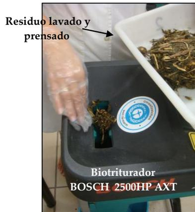
Fig. 3.8. Triturado secundario de los RAI tras su lavado y prensado.
