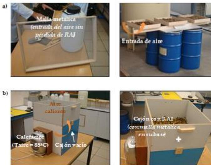
Fig. 3.11. Sistemas diseñados para llevar a cabo las pruebas (a) Secado atmósfera (SA); y (b) Secado aire caliente (SC) de los RAI.
