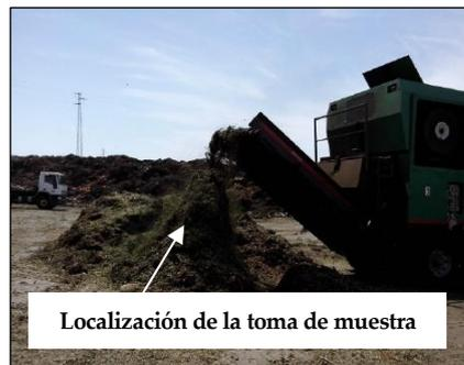
Fig. 2.6. Pila de RAI tras su trituración en la planta de tratamiento de residuos.
