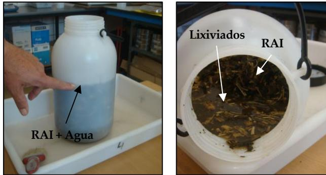
Fig. 3.2. (Izda.) Recipiente lavado de los RAI. (Drcha.) Detalle del residuo lavado.
