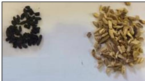
Fig. 4.16. (Izqda.) Char retirado tras ensayos; (Dcha.) Residuo original alimentado.
