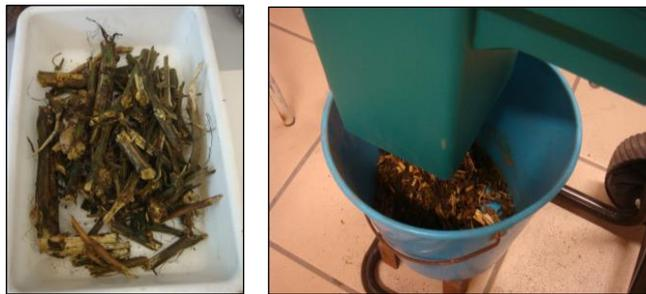
Fig. 2.18. Restos leñosos de gran tamaño (izda.) y trituración de estos con triturador BOSCH AXT Rapid 2000 (dcha.)
