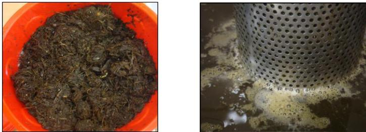
Fig. 3.25. (Dcha.) Recepción de la muestra M-07 en los laboratorios de la ETSI. (Izda.) Lixiviados procedente de la muestra M-07 tras su prensado sin lavado previo (Ensayo T-03).
