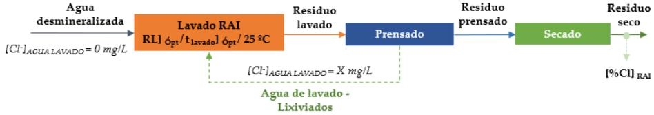
Fig. 3.10. Procedimiento experimental seguido para la evaluación de la reutilización agua de lavado.
