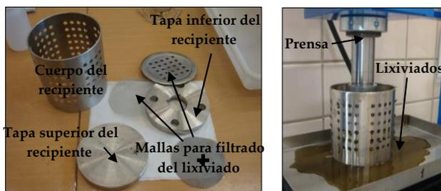
Fig. 3.7. (Izda.) Recipiente diseñado para el prensado de los RAI. (Drcha.) Prensa adquirida para el desarrollo de los trabajos en laboratorio.
