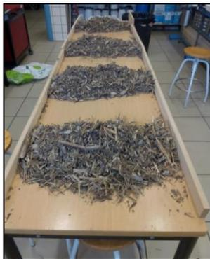
Fig. 4.9. Obtención de la muestra representativa a partir del cuarteo de la inicial seca y cribada.
