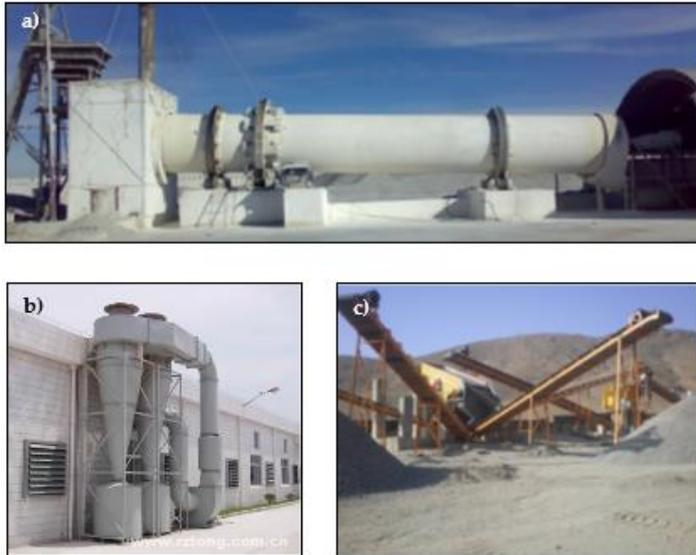
Fig. 3.29. Sistema de secado de los RAI propuesto: a) Secador rotativo; b) Colector de polvo; c) Cintas transportadoras.
