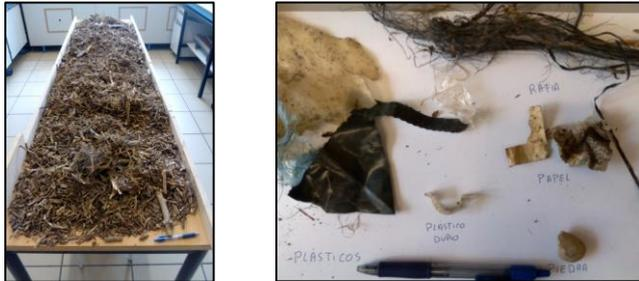
Fig. 4.8. (Izda.) Muestra M-08 tras su secado con aire a 40 °C. (Dcha.) Impurezas retiradas del residuo.
