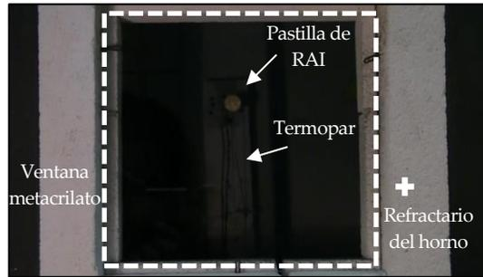
Fig. 3.13. Equipo utilizado para la estimación de la temperatura de ignición de los residuos agrícolas de invernadero.
