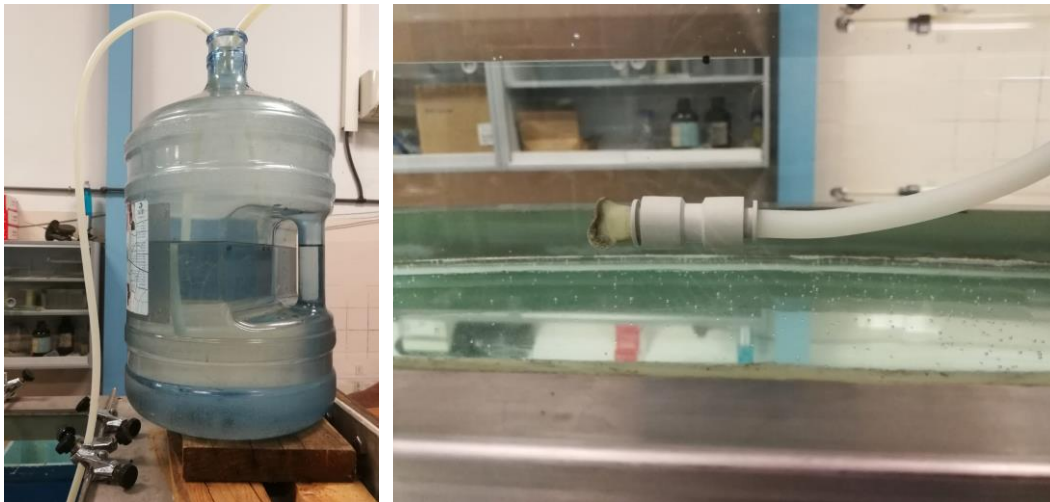
Figura 3-3. (a) A la izquierda, depósito utilizado para el vertido de partículas ABS. (b) A la derecha, tubo para la inyección de partículas ABS en el canal.
