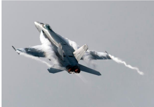
Figura 1-5. Vórtices formados en las superficies sustentadoras de un F/A-18E Super Hornet. [James R. Evans, Marina de los EEUU] (Océano Pacífico, 2011) [5]
