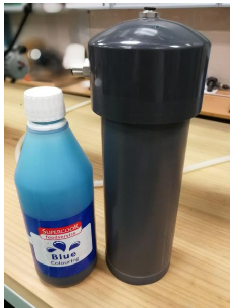
Figura 5-1. Tinta y depósito utilizados para la visualización de la corriente
