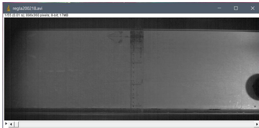
Figura 4-4. Imagen de la regla utilizada para calibrar la imagen
