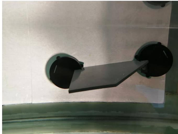
Figura 3-9. Placa plana con flecha positiva fijada en el canal
