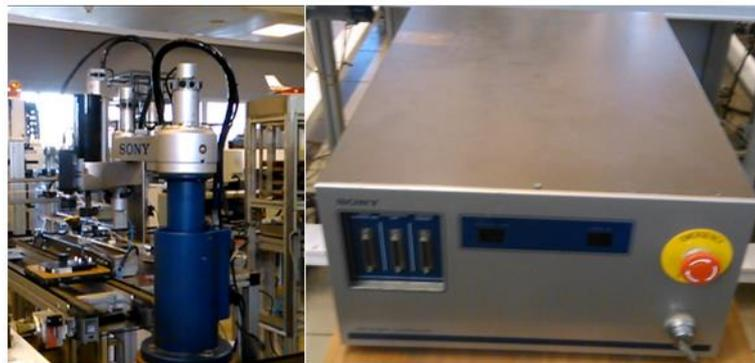
Figura 10-1. Manipulador y Unidad de Potencia del SONY SRX 4CH.
