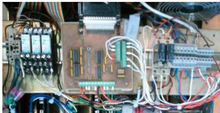
Figura 10-2. Cableado del arreglo relés e interfaz PLC y Unidad de Potencia.
