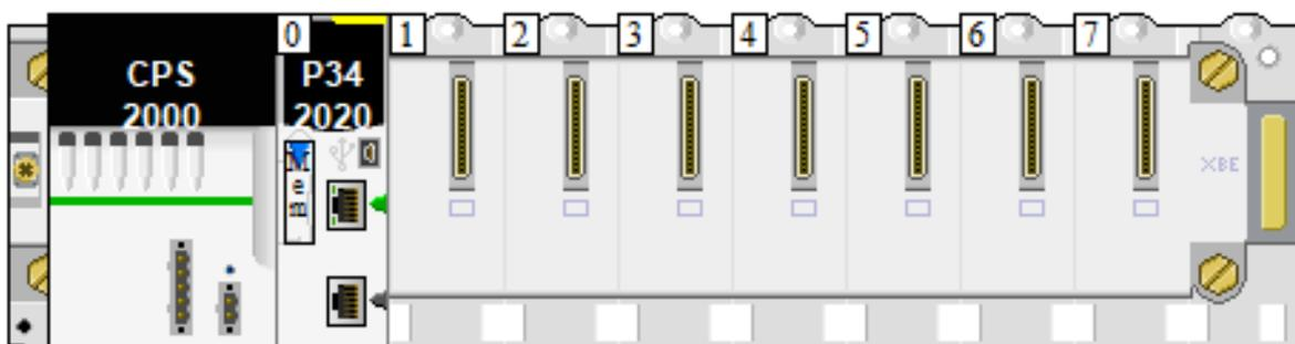
Figura 4-4. Procesador BMX P34 2020 para PLC Modicon M340 Schneider Electric.
